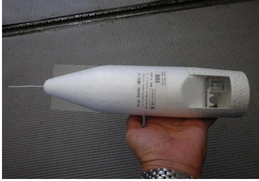
図-2 観測に使用するドロップゾンデ。自由落下しながら、気圧、温度、湿度、高度、風向・風速を計測し、データを伝送する。本体は環境に配慮した生分解性素材でできている。
