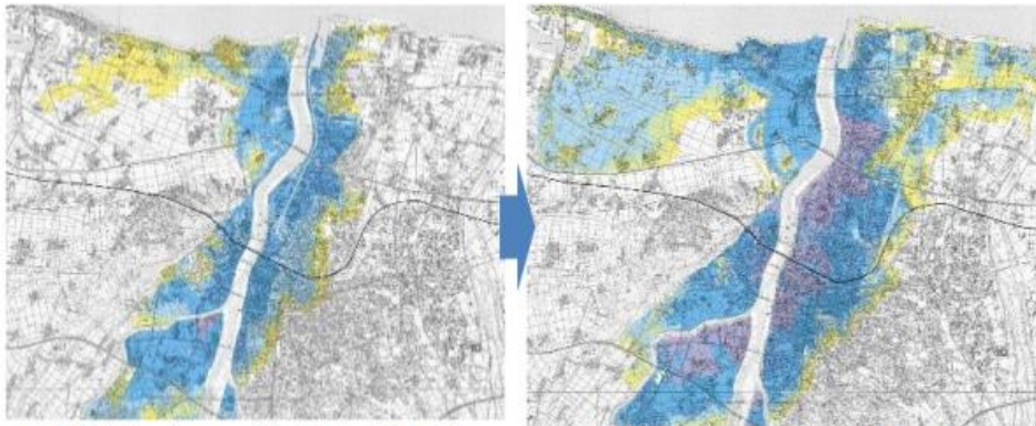
河川整備において基本となる降雨を前提とした浸水想定区域
