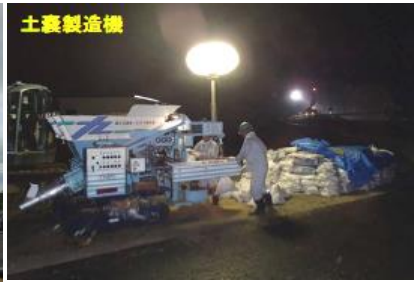
土のう製造機の貸与 H24年九州・北部豪雨
